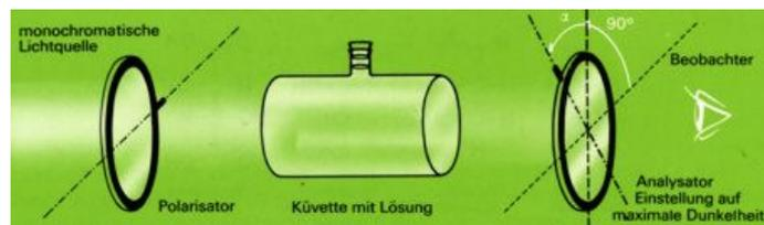
Zunächst wird die Küvette mit einer optisch inaktiven Flüssigkeit (z.B. Wasser) gefüllt und dann der Analysator so lange gedreht, bis hinter ihm eine maximale Lichtauslöschung (dunkel) zu beobachten ist: Stellung des Analysators senkrecht zur Stellung des Polarisators. Wird das Wasser z.B. durch Glyceraldehyd ersetzt, so muss der Analysator - um erneut maximale Auslöschung zu erhalten - um einen bestimmten Winkel gedreht werden.
