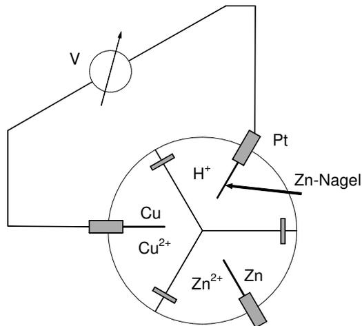
Aus den Bierdeckeln schneidet man sich kleine Filzreiter, die mit einer Kerbe versehen, als Salzbrücke dienen. Sie werden zu diesem Zweck mit einer Kaliumnitratlösung beträufelt
