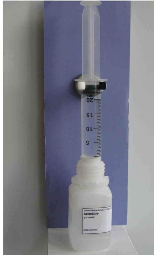
Zugabe der Salzsäure: Die Salzsäure wird aus der kleinen Spritze in die große gedrückt, bis der Kolben bei 20 mL steht.
