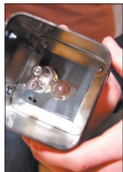
Das verspiegelte Doseninnere verstärkt die Wirkung des UV-Lichts auf die EDTA-Probe.
